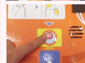
3. 自動解析(自動解析ガイドが流れている時、体に触れてはいけません)し、必要であれば電気ショックのガイドが流れますので、点滅しているボタンを押します(この時、体には絶対触れないでください)。
